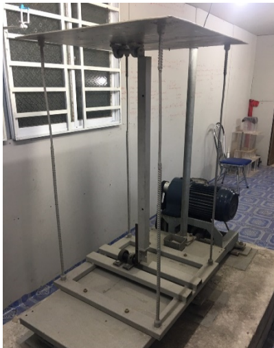
Hình 5. 5 Khung thép được thí nghiệm giảm chấn bằng MTLTD
