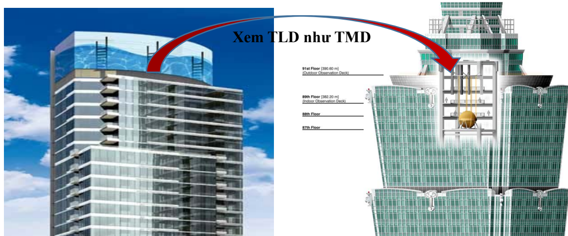
Hình 2. 1 Nguyên lý hoạt động của TLD tương tự TMD
