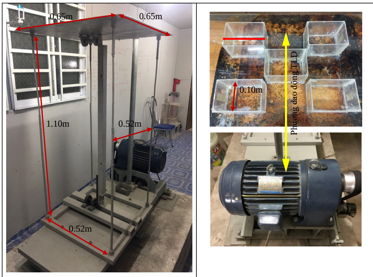
Hình 5. 7 Kích thước hình học và chiều chuyển động khung thí nghiệm
