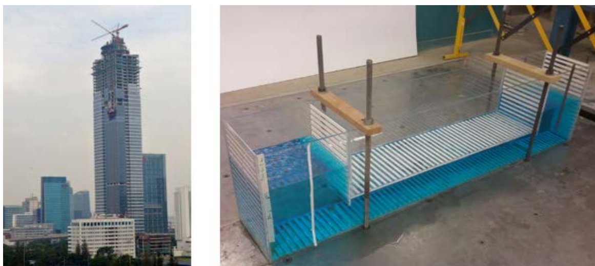
Hình 1. 12 Toà nhà Gama với mô hình TLD thí nghiệm
