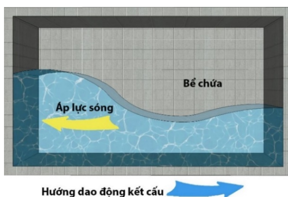
Hình 1. 3 Dao động của sóng bên trong TLD
