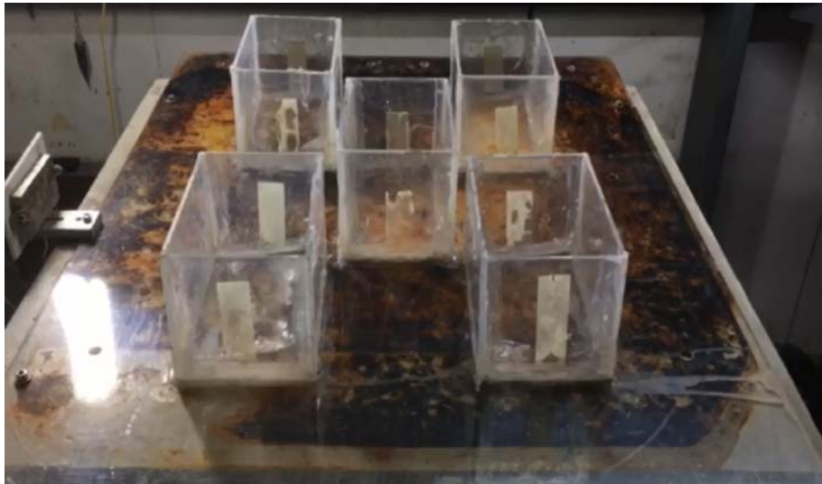
Hình 4. 12 Hệ bể chứa 0.15m \times 0.10m \times 0.10m (DxRxH)
